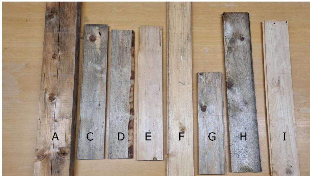
Figur 4: Brädor som provtagits vid lagringsplats och som analyserats på RISE laboratorium A) hyvlat regelvirke, (C) spontat virke med sågad yta, (D-H) spontat virke med hyvlat yta, (I) spontat virke med sågad yta.
