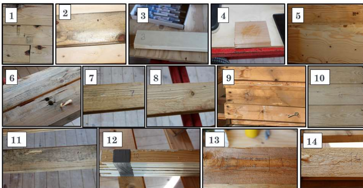
Figur 3: Virkesprover testade i fält i projektet Rymdrum, Onsala. (1) Hyvlad väggspont på befintlig vägg, (2) Hyvlad väggspont (3) Ny list av hyvlad ask, (4) Nytt värmebehandlat virke, (5) Plywood (6) Hyvlad väggregel, (7) Spontat hyvlad virke (8) Spontad hyvlad virke, (9) Undersida fönsterkarmar (10) Väggspont på befintlig vägg, (11) Spontad hyvlad virke, (12) Baksida målad trälist, (13) Sågad regel, (14) Spontat virke med sågad yta.
