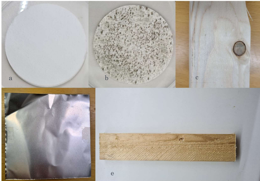
Figur 7: Referensprover av (a) rent glasfiberfilter, (b) filter med kraftig aktiv mögelpåväxt, (c) hyvlad gran, (d) aluminiumfolie, (e) sågad gran. För material c-e ingick dels prover med aktiv omfattande påväxt, dels prover utan sådan påväxt. Påväxten var inte synlig för blotta ögat.
