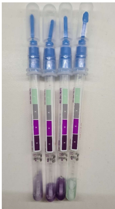
Figur 6: PRO-Clean testkit för mögelsvamp efter provtagning på 4 olika materialytor.
